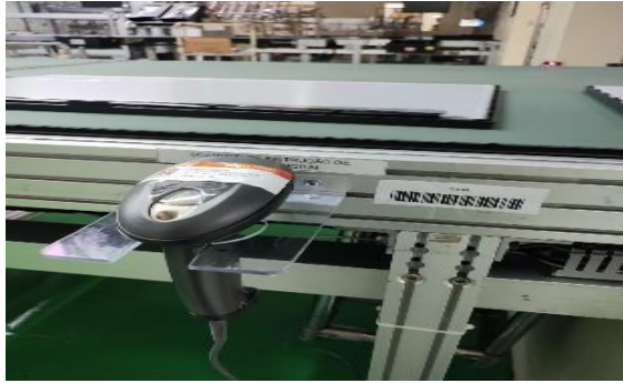
Figura 6 – Scanner no início da linha de produção L04
